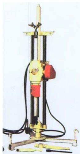
Slika 2-2. Hidraulična rotacijska bušilica (Michelleti machine)
