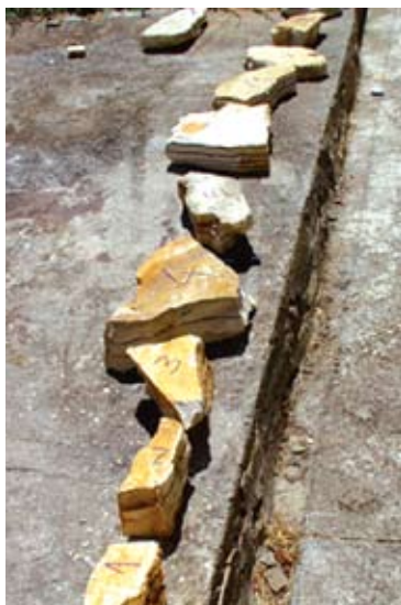
Sl. 9, 10 i 11 Uzorci sa "zatvorenim" slojnicama prije i poslije tretiranja vodom
