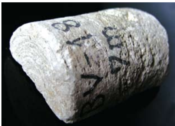
Sl. 2. Kamena jezgra izbrušena u osnovici zbog nepravilnog bušenja (porozni vinicit)
