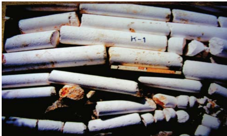
Sl. 3. Primjer neuspjelog bušenja na ležištu prirodnog kamena
