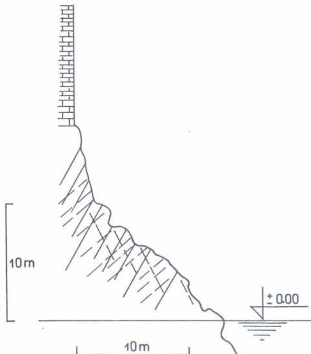
Sl. 2 Shematski prikaz diskontinuiteta (profil A-A, blok 4)
