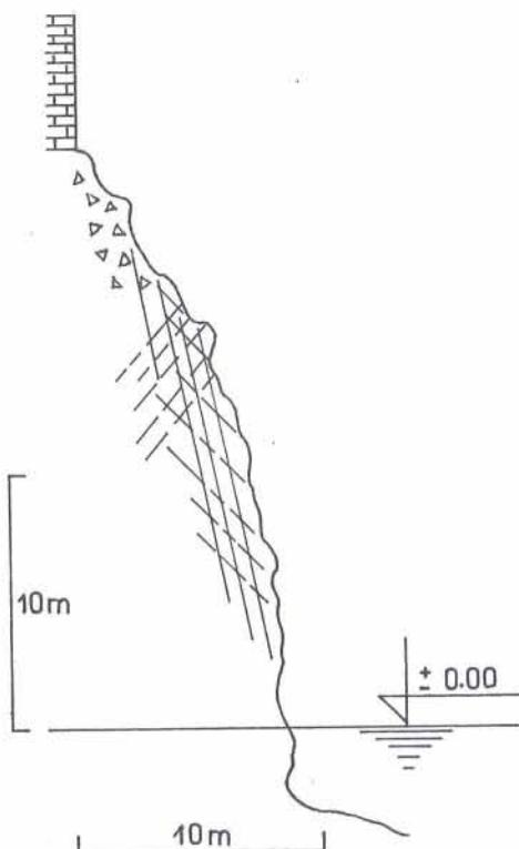
Sl. 4 Shematski prikaz diskontinuiteta (profil C-C, blok 2)
