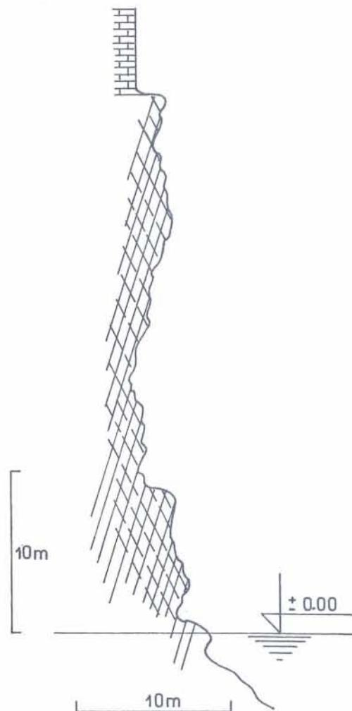
Sl. 3 Shematski prikaz diskontinuiteta (profil B-B, blok 3)
