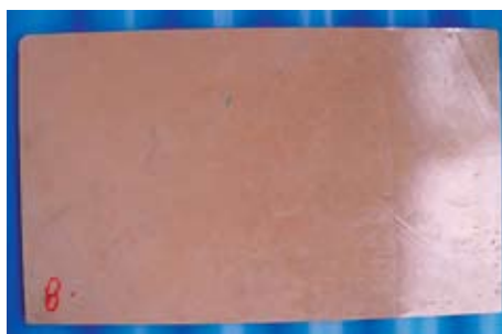
Uzorak 8 – Sivac premazan samo zaštitnim sredstvom
