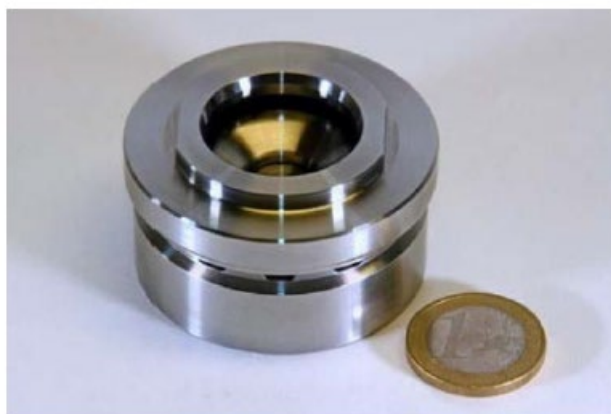
Slika 2-31. AICV pored kovanice od jednog eura (Aakre et al., 2013)
