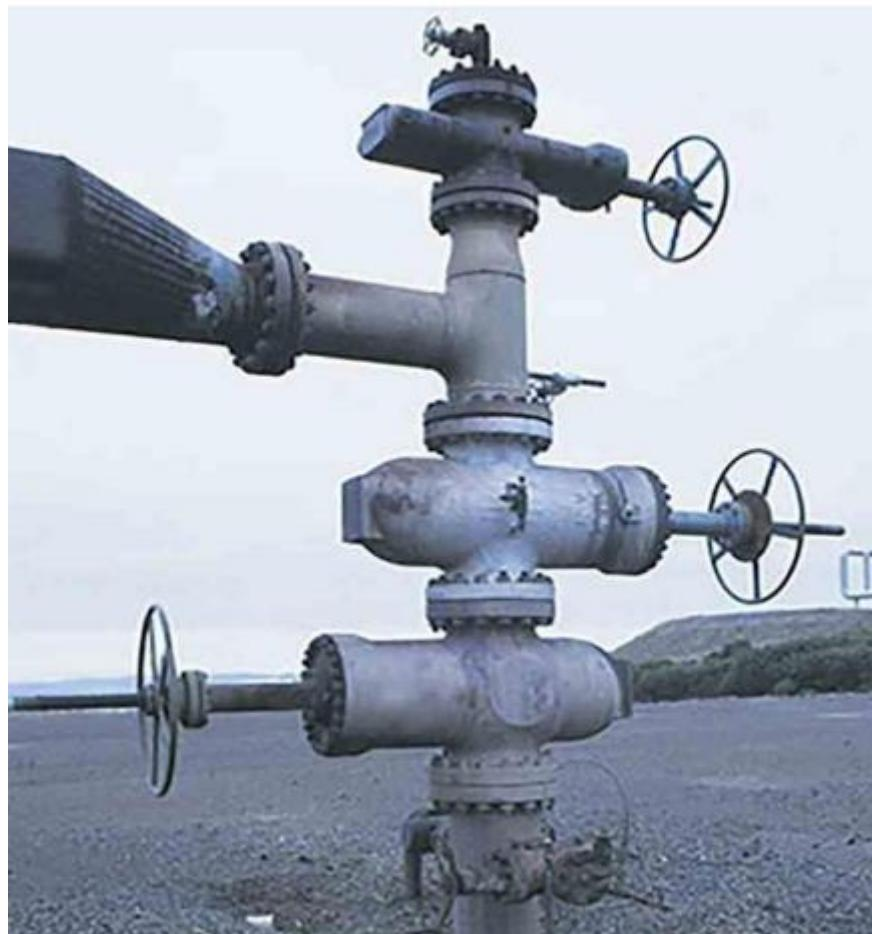
**Slika 5-2.** Bušotinska glava geotermalne bušotine (Schlumberger, 2020)
