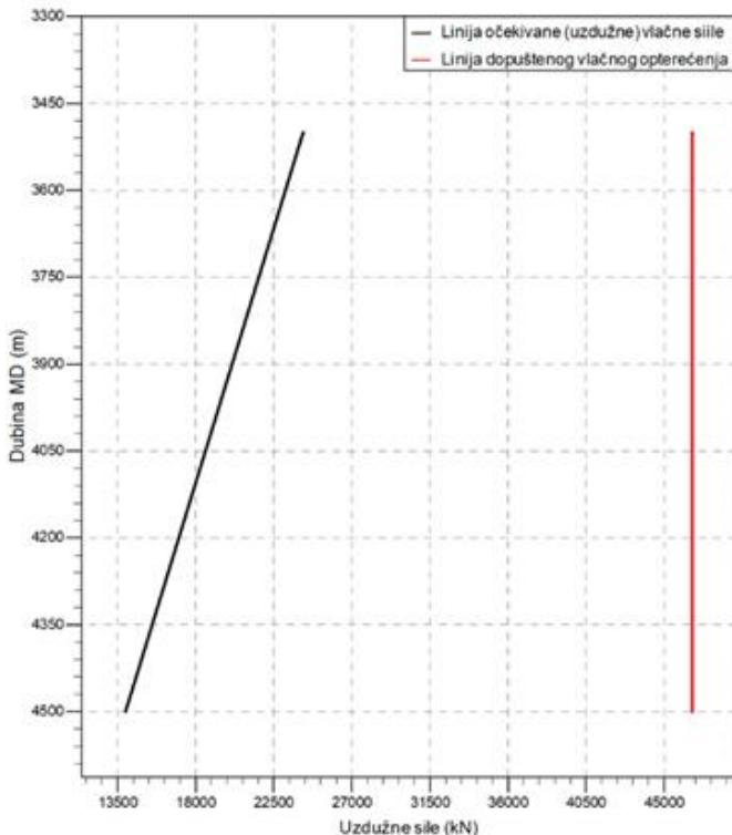
**Slika 6-8.** Grafički prikaz rezultata proračuna naprezanja lajnera s prorezima vanjskog promjera 0,178 m uslijed djelovanja očekivane vlačne sile u odnosu na vrijednost dopuštenog vlačnog opterećenja (Zadravec, 2023).
