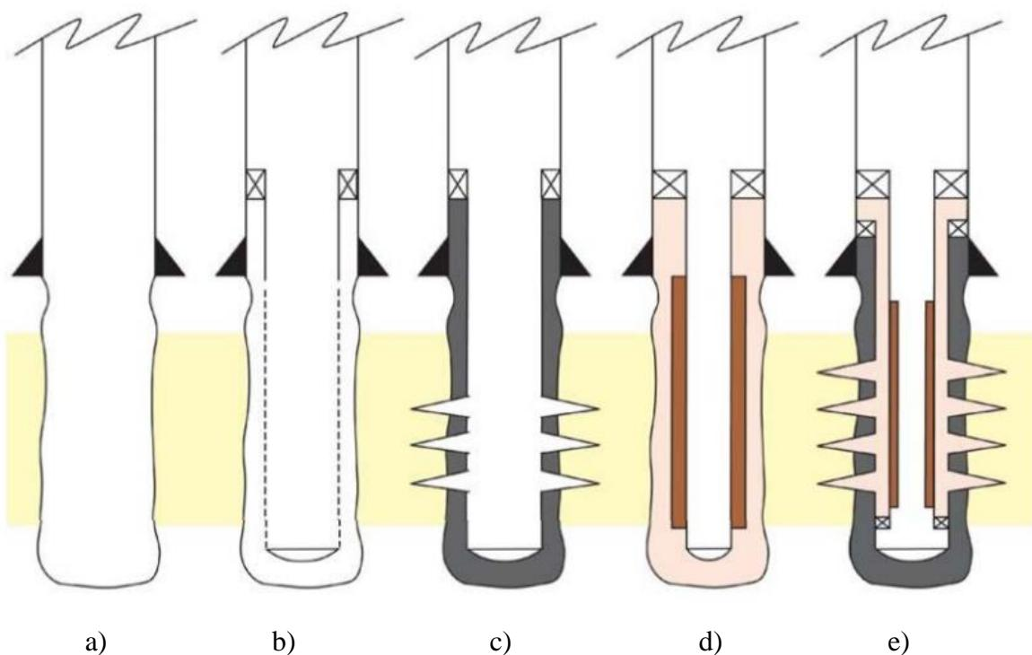
**Slika 5-1.** Shematski prikaz različitih načina opremanja bušotina (Bellarby, 2009)
