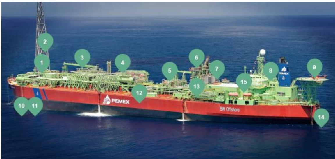
Slika 3-2. Prikaz palubnih objekata odobalnog postrojenja za proizvodnju, skladištenje i iskrcaj nafte (Mentes i Mollaahmetoglu, 2019)
