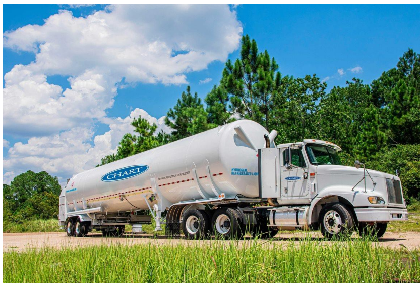
Slika 3-2. Kamion s kriogenim spremnikom (ESG News, 2022)
