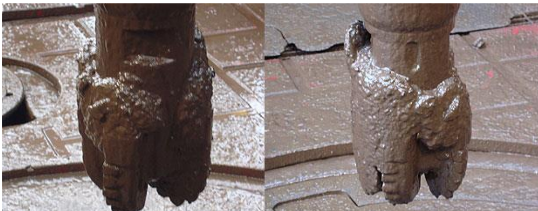
Slika 2-2. Nakupljeni nabušeni stijenski materijali unutar rezne strukture dlijeta (Drilling formulas, 2014).
