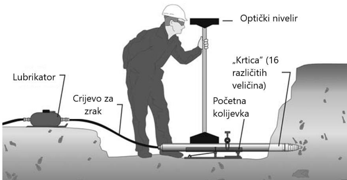
Slika 4-11. Prikaz rada „krtice“ (TT Technologies, 2013)
