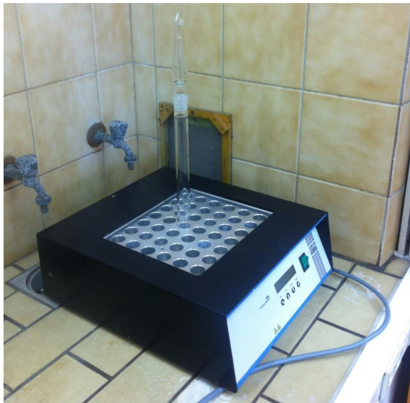
Slika 3-4. Digestor s „klopkom“
