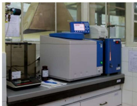
Slika 4-3. Kalorimetar (IKA-C2000, Njemačka)
