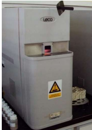
Slika 4-2. Elementni analizator (Leco TruSpec, SAD)
