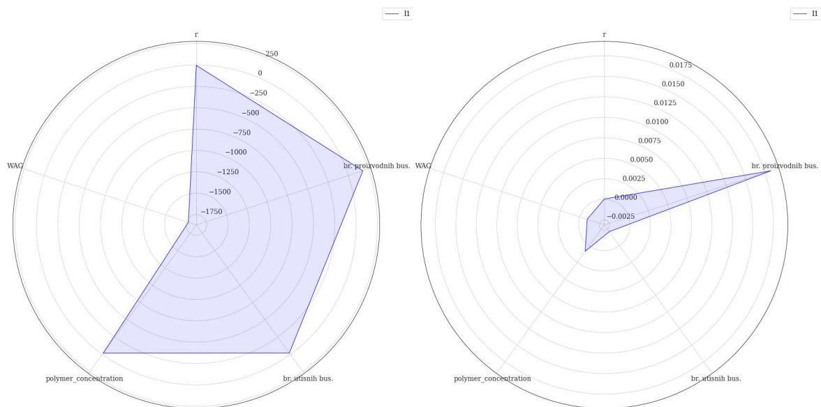
Slika 4-119 Težinski faktori u odnosu na retenciju (lijevo) i EOR iscrpak (desno) za skup simulacijskih slučajeva naftnog polja I1
