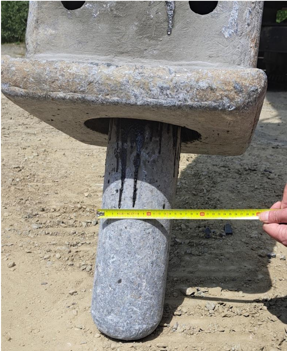
Slika 3-4, Promjer i oblik radnog alata u kamenolomu Vetovo
