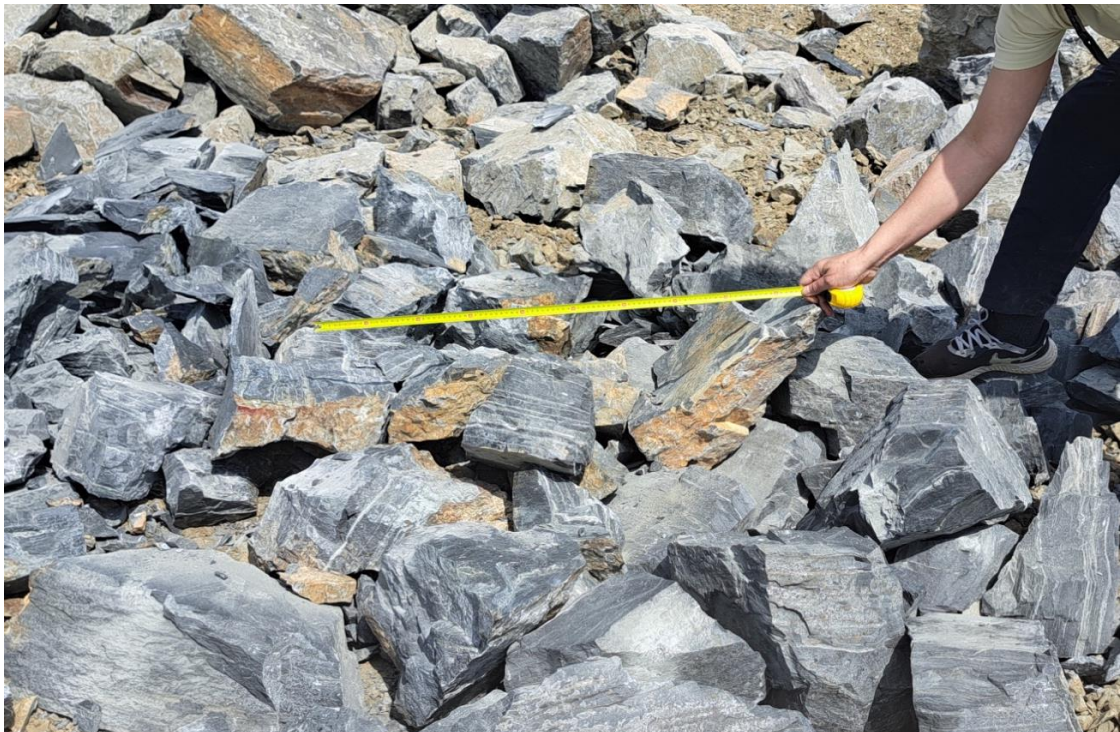
Slika 3-6, Izgled materijala nakon usitnjavanja
