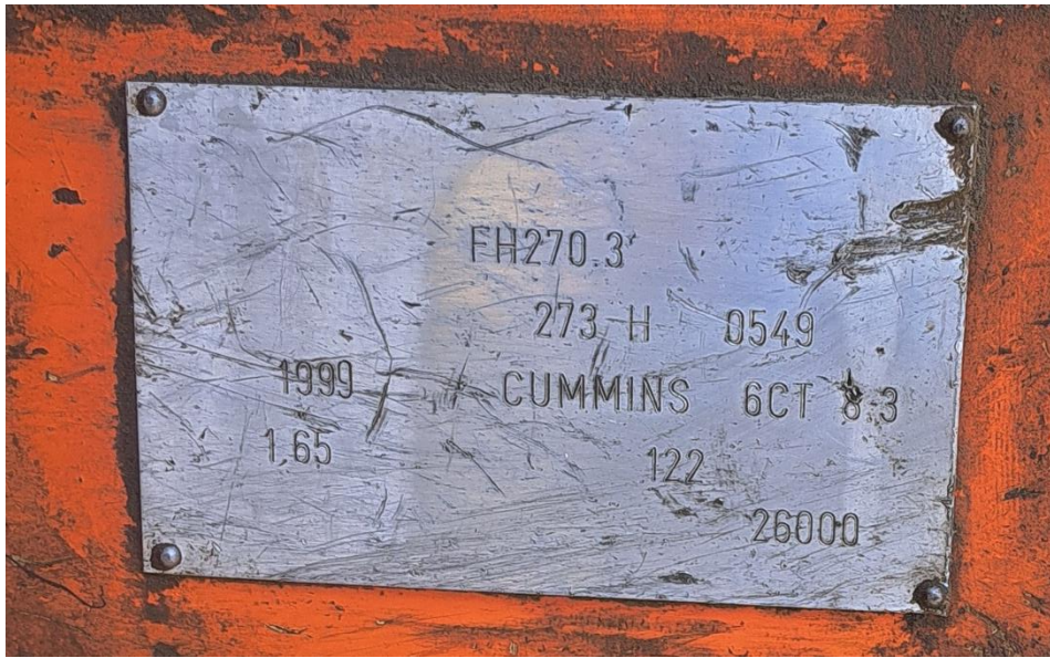
Slika 3-2, Bager Fiat FH270.3 specifikacijska pločica
