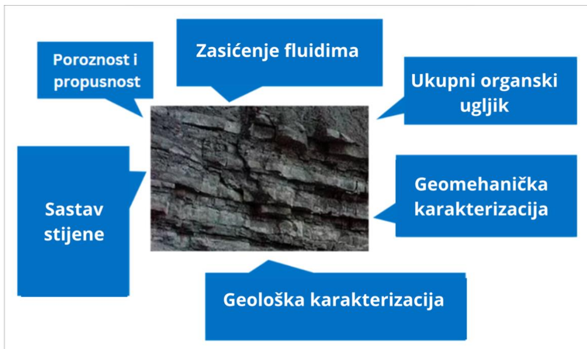
Slika 6-2. Petrofizičke značajke ležišnih stijena u ležištu Nene Marin (preuređeno prema Ma i Holditch, 2015)
