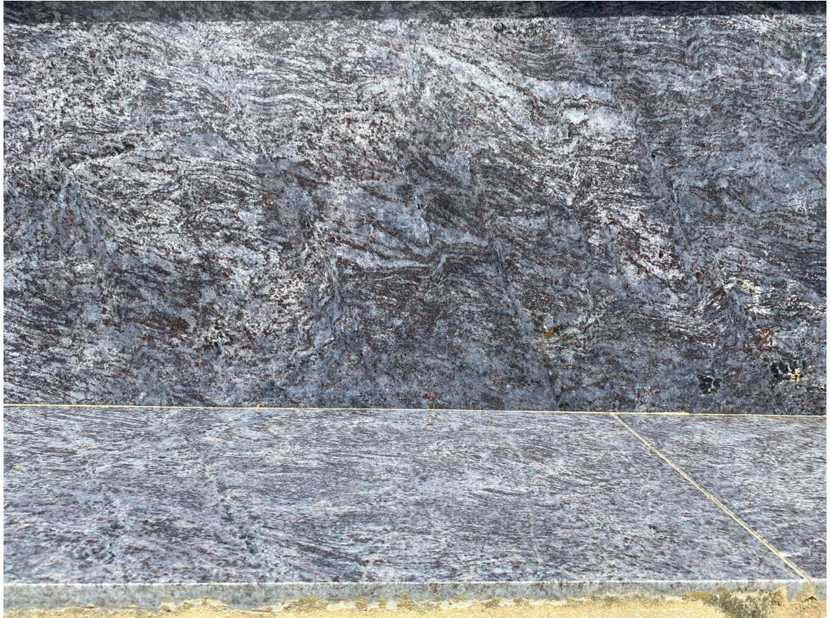
Slika 3-14 Prednji pogled na grobnicu lokalnog groblja Križevčec, gdje se na kamenim pločama vidi izmjena leukokratskih i melanokratskih lamina u migmatitu.
