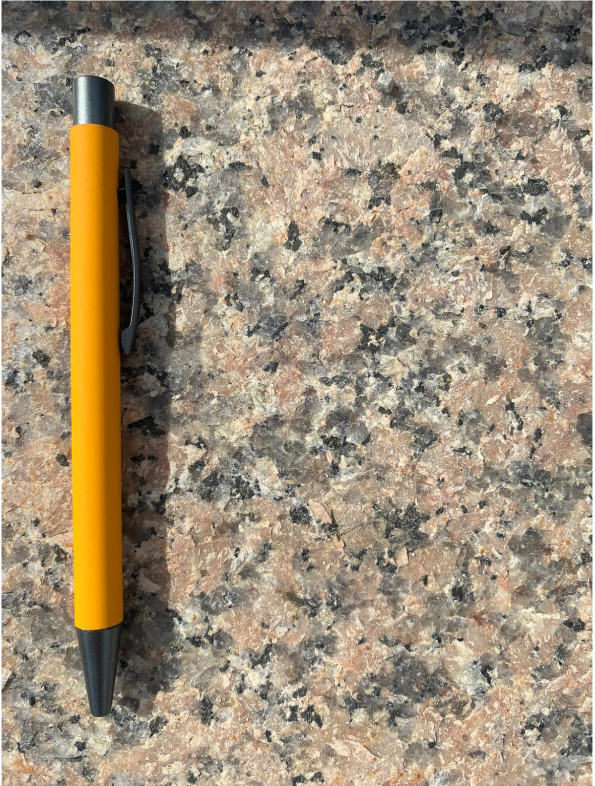
Slika 3-7 Detalj varijeteta granita s ružičastim alkalijskim feldspatima. Stepenice sportske dvorane Sveti Ivan Zelina s vidljivim mineralima kvarca, alkalijskog feldspata i biotita. Mjerilo: kemijska olovka duljine 14 cm.
