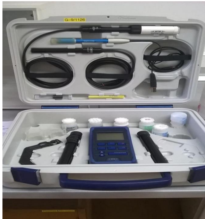
Slika 4-2 Uređaj za mjerenje pH Multi 340i WTW (Kralj, 2015)
