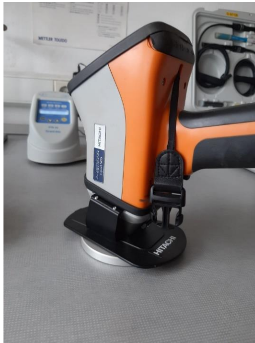
Slika 4-4 Elementna analiza upotrebom pXRF uređaj
