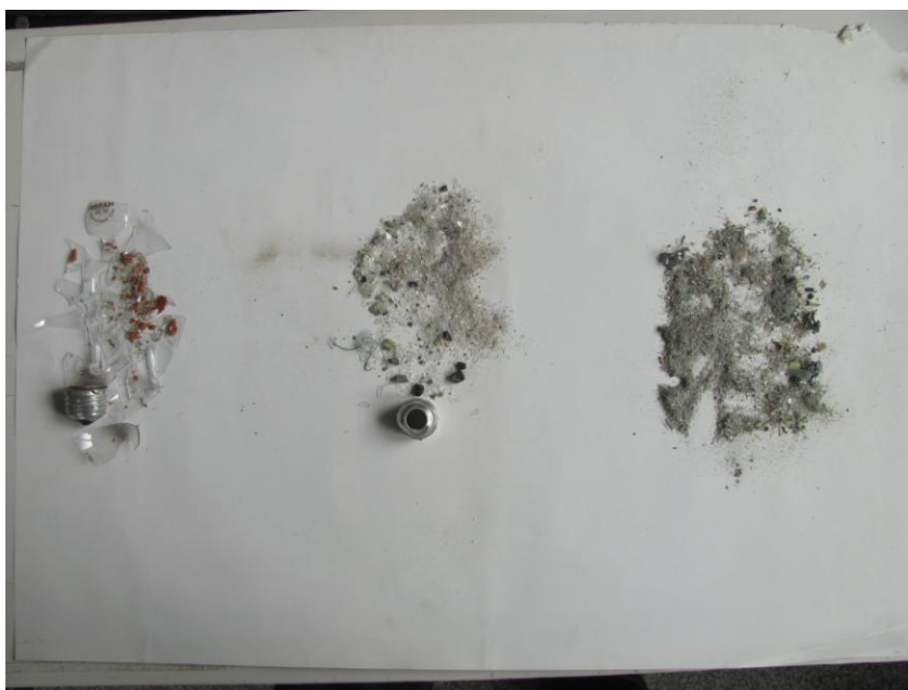
Slika 5-1. Žarulja nakon drobljenja u čeljusnoj, udarnoj i drobilici čekićari (s lijeva nadesno)
