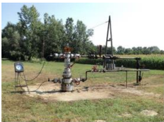
Slika 2-3. Naftna bušotina s plinskim podizanjem (Pletikapić et al., 2015)
