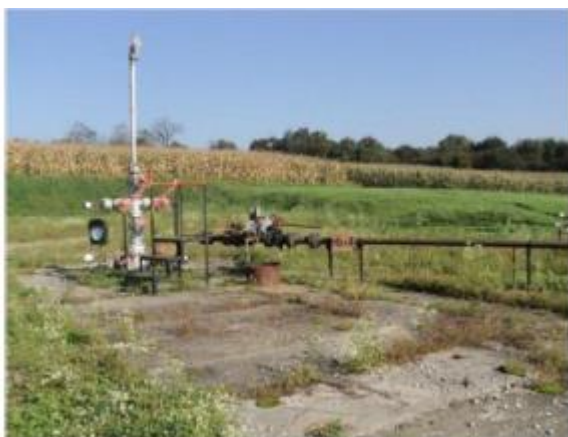
Slika 2-2. Naftna eruptivna i plinska eruptivna bušotina (Pletikapić et al., 2015)
