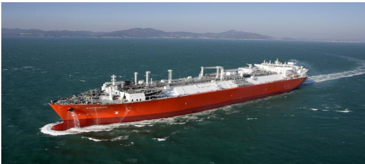
Slika 2-4. Brod za transport UPP-a sa sustavom za uplinjavanje (EXCELERATE ENERGY, 2015)
