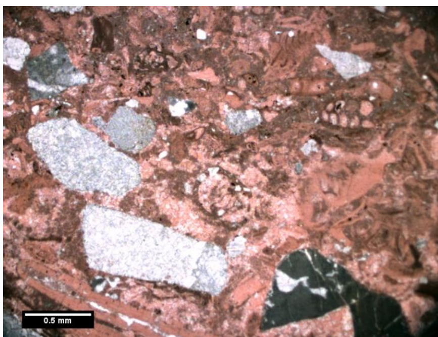
Slika 4-19. Mikrofotografija uzorka M48 - valutice trijaskih dolomita i badenski fosili u karbonatnom vezivu
