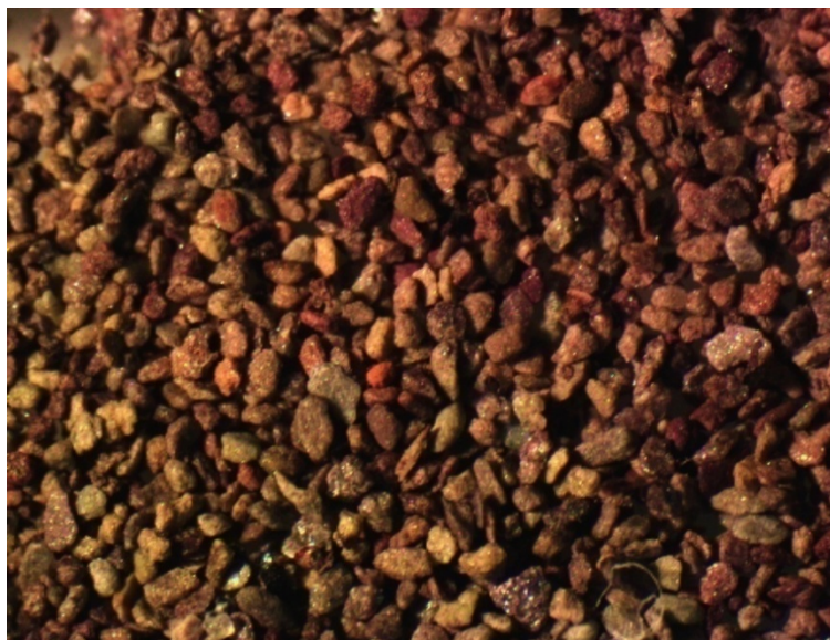
Slika 4.12 Nemagnetna frakcija uzorka sedimenta 5160 izdvojena pri 1.2 A
