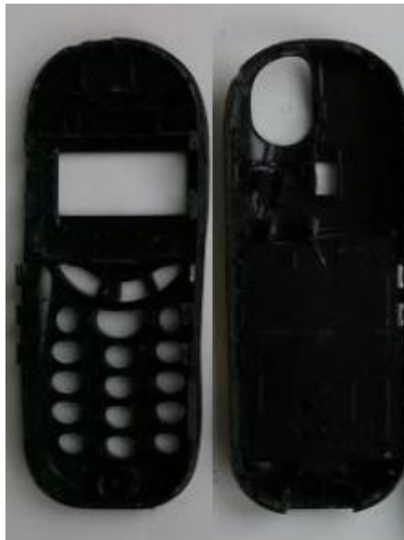
Slika 3-10. Primjer maske mobilnog telefona
