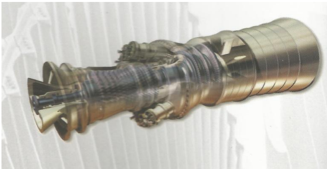
Slika 4-7. Plinska turbina bloka L (HEP Proizvodnja d.o.o., 2011a)
