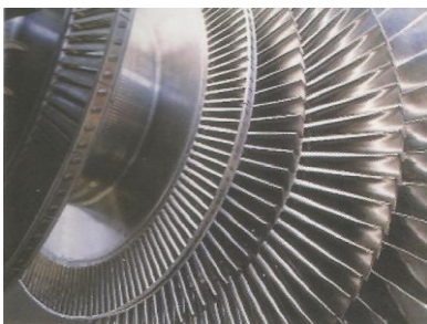
Slika 4-8. Segment parne turbine bloka L (HEP Proizvodnja d.o.o., 2011a)
