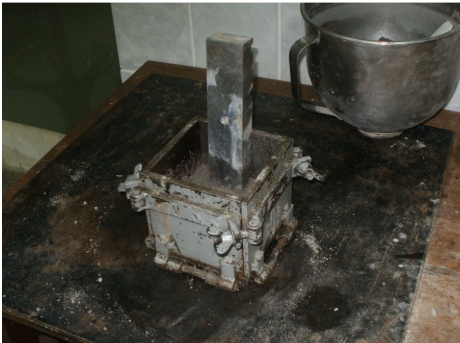
Slika 31. Ugradnja betona u kalup
