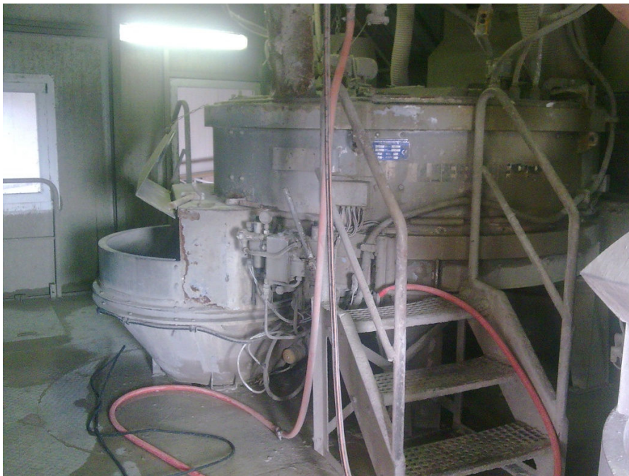
Slika 35. Miješanje betona za izradu opločnika Liebherr, tip RIM, Zagorje Tehnobeton, d.d., pogon Varaždin
