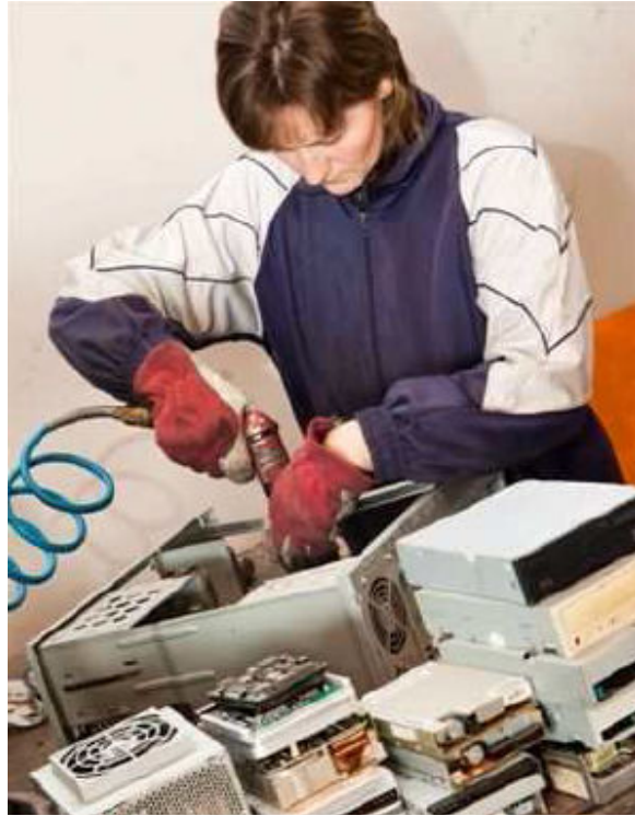
Slika 12. Predobrada EE otpada - ručno odvajanje TP, Spectra Media d.o.o., pogon Virovitica
