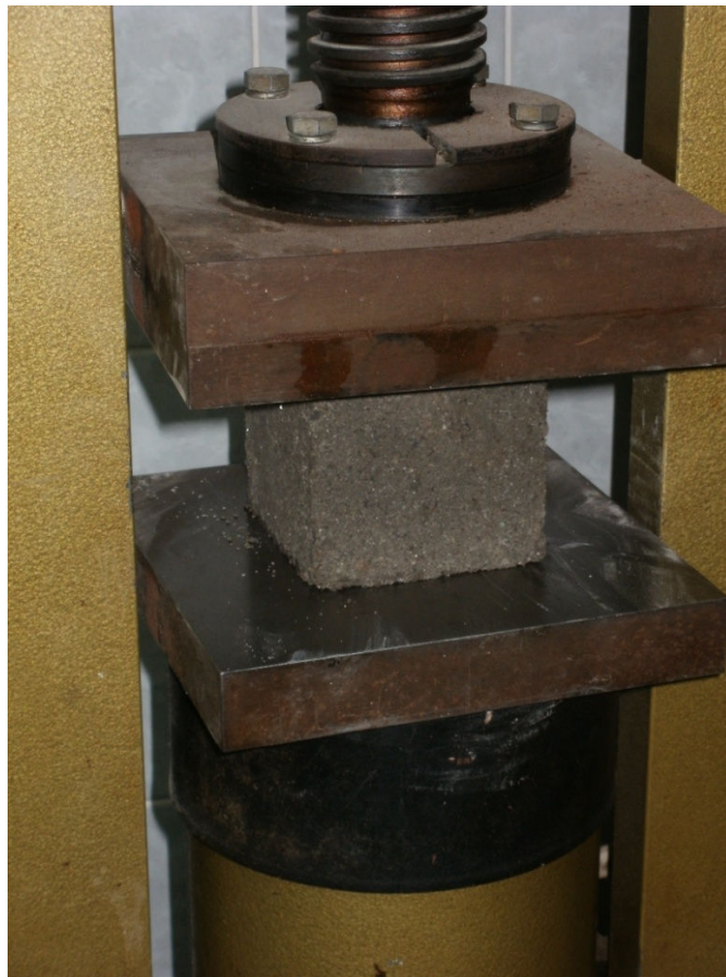
Slika 34. Ispitivanje tlačne čvrstoće u laboratorijskoj preši
