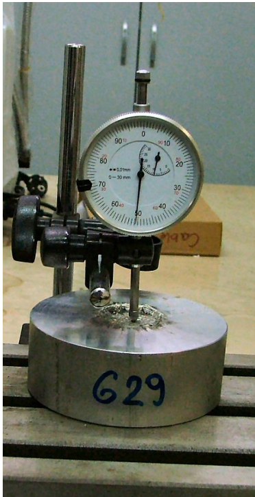
Slika 6-23. Određivanje udubljenja na Al pločici.
