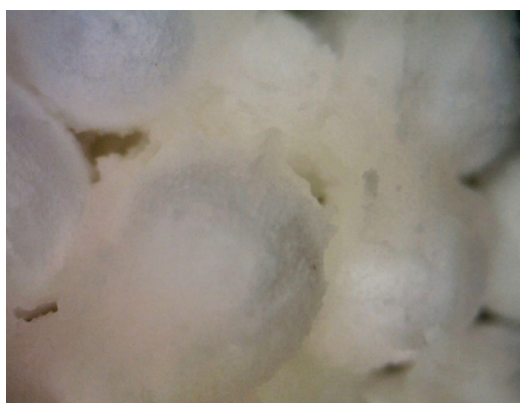
Slika 6-8. Struktura mješavine Lambrexa 1 i EPS-a (1,5 mm – 3,5 mm) u omjeru 40:60 (uvećanje 50 \times , mikroskop Dino-Lite Pro).
