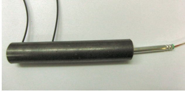
Slika 6-18. Fotografija mjernog postava u čeličnoj cijevi unutarnjeg promjera \varnothing 20 mm.
