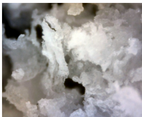
Slika 6-9. Struktura mješavine Lambrexa 1 i EPS-a (0,18 mm – 0,25 mm) u omjeru 40:60 (uvećanje 500 \times , mikroskop Dino-Lite Pro).
