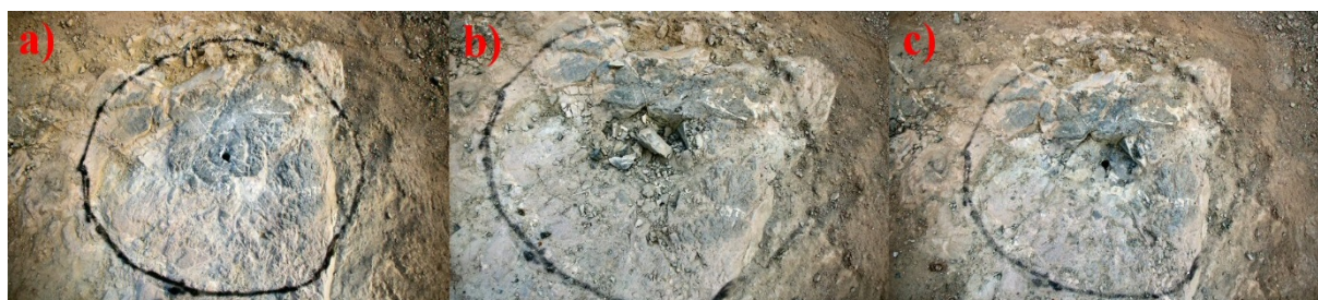
Slika 6-54. Lijevak s najvećim odlomom (M+EPS 40:60).
