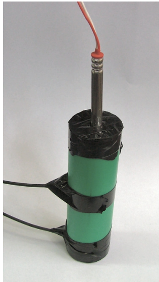
Slika 6-14. Fotografija mjernog postava u PVC cijevi unutarnjeg promjera \varnothing 20 mm.
