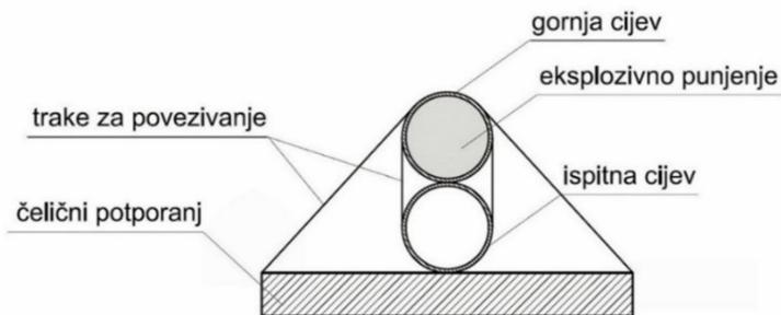
**Slika 4-4.** Shematski prikaz postava mjerjenja kod ispitivanja s dvostrukim cijevima.
