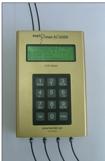
Slika 5-4. Elektronički sat Explomet – Fo 2000.
