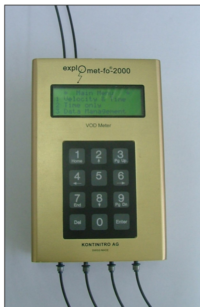
Slika 5-4. Elektronički sat Explomet – Fo 2000.
