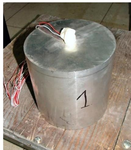
**Slika 5-12.** Blok pripremljen za ispitivanje.
