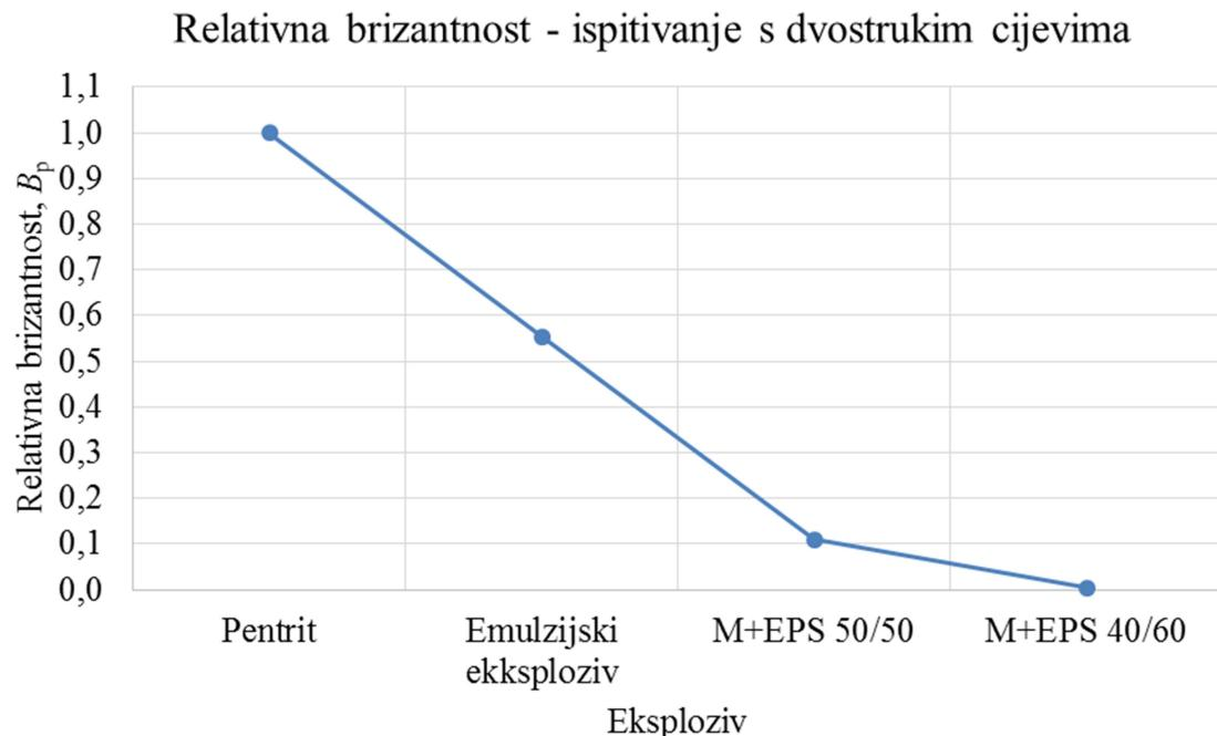
**Slika 6-4.** Relativna brizantnost – ispitivanje s dvostrukim cijevima.
