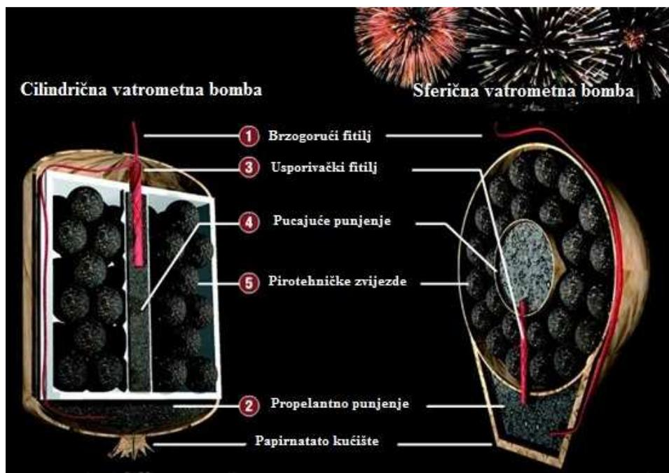
**Slika 4-1.** Konstrukcija sferične i cilindrične bombe (roundeyespyro, 2015)
