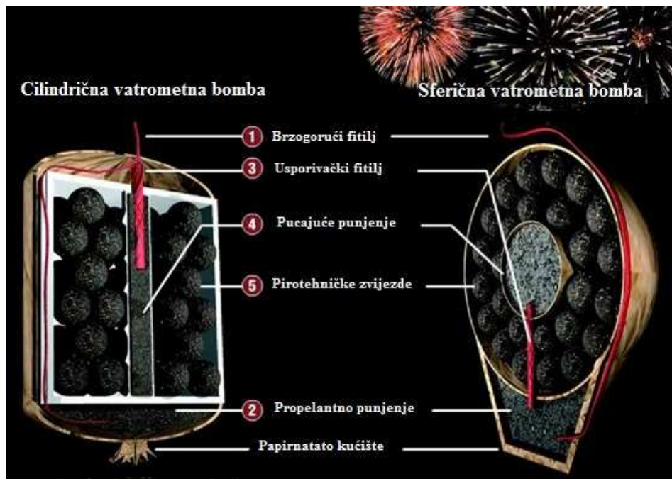
Slika 4-1. Konstrukcija sferične i cilindrične bombe (roundeyespyro, 2015)
