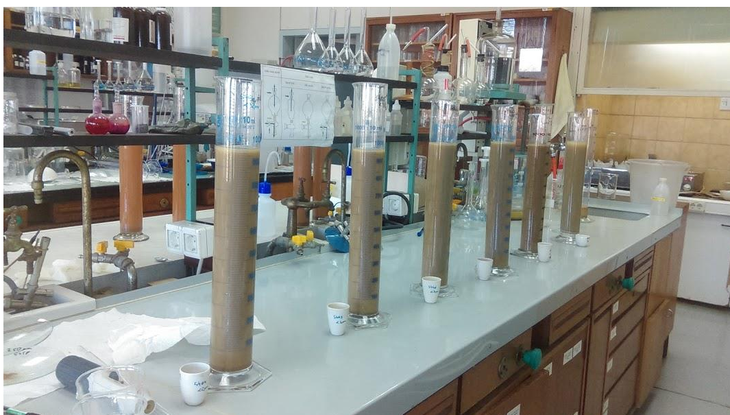
Slika 4-5. Izvlačenje frakcija < 2 \mu\text{m} (foto: Tin Borovčak)
