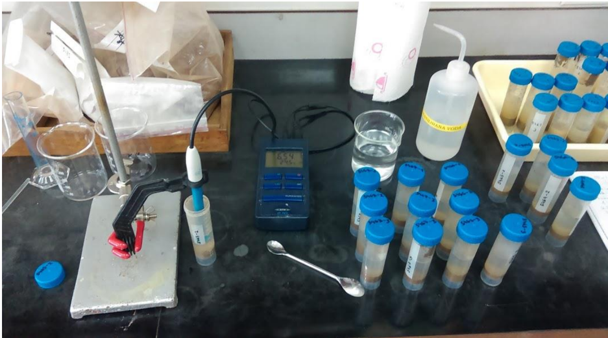
Slika 4-3. Mjerenje pH vrijednosti (foto: Dražen Tumara)
