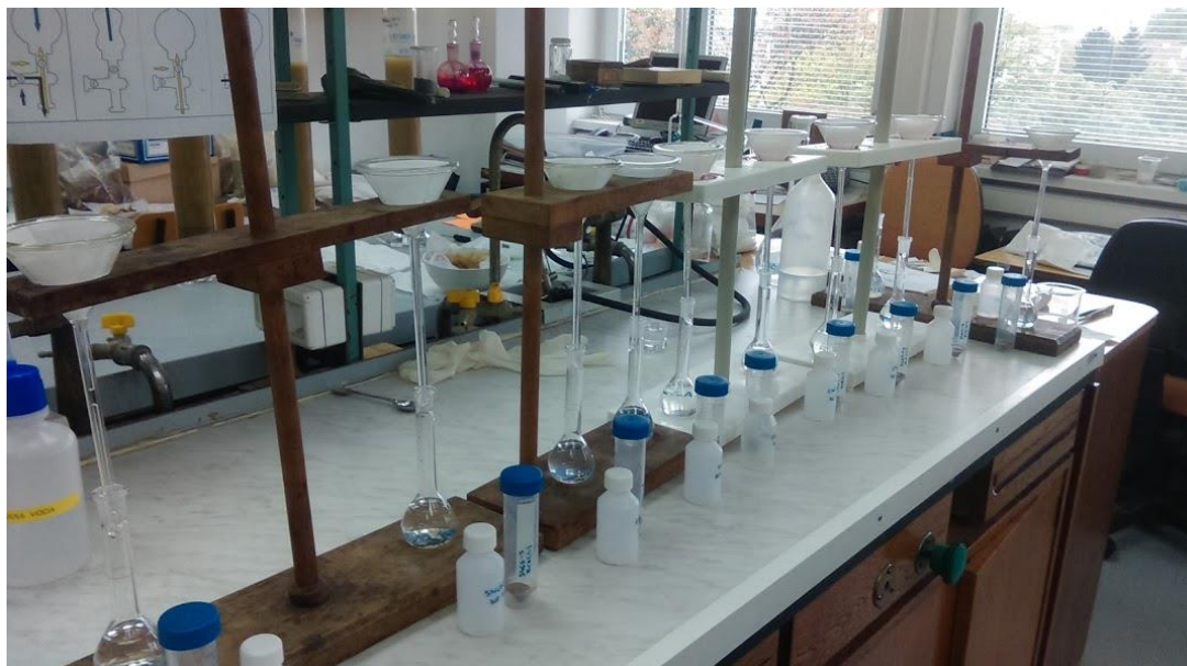
Slika 4-7. Filtriranje uzoraka tijekom sekvencijska ekstrakcijske analize (BCR)
