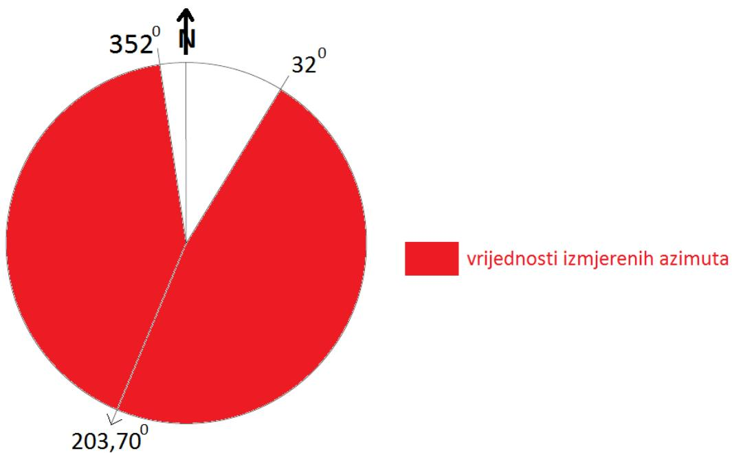
*Slika 4.2.* Grafički prikaz maksimalne i minimalne vrijednosti azimuta. Shematski je prikazana i srednja vrijednost azimuta. Crvenom bojom označeno je područje u kojem se nalaze vrijednosti izmjerenih azimuta.
