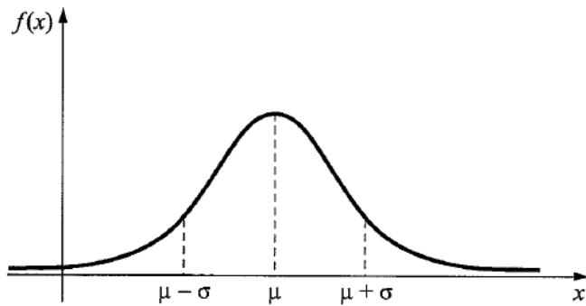
*Slika 4.6. Normalna razdioba (iz Pfaff, 2012). Na slici je vidljivo da je graf zrcalno simetričan s obzirom na pravac  $x=\mu$  koje je paralelan osi  $y$ , a prolazi kroz očekivanje  $\mu$ . Točka maksimuma nalazi se na  $x=\mu$ , a točke inflesije  $x = \mu - \sigma$  i  $x = \mu + \sigma$ . Zbog simetričnosti lijeve i desne strane često se naziva i funkcijom zvonasta oblika.*
