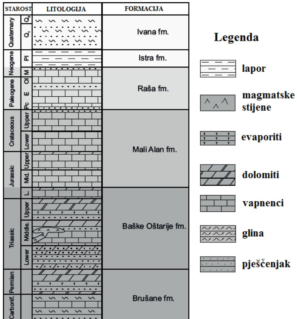
*Slika 3.6. Shematski prikaz izdvojenih formacija na temelju četiri opisanih megasekvencija (iz *Velić et al., 2015*, izmjenjeno). Na slici su šrafurama prikazane naslage koje se nalaze unutar pojedinih formacija te starost pojedinih nasлага.*
