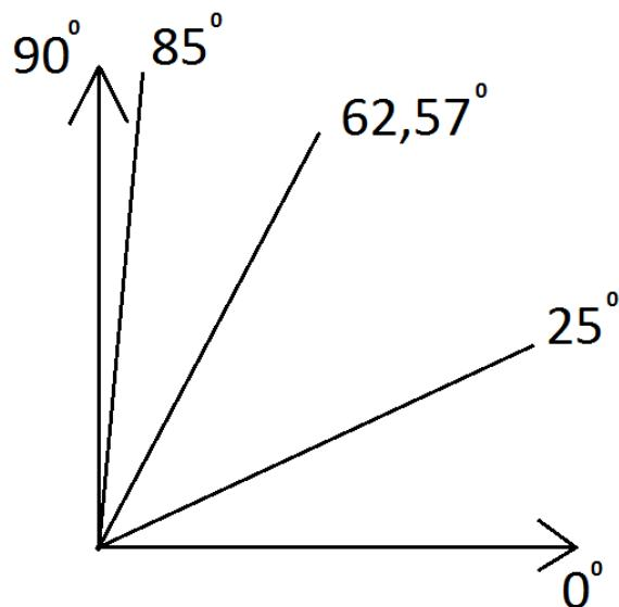
**Slika 4.3.** Grafički prikaz izmjerениh nagiba slojeva. X – koordinata označava nagib sloja od  $0^\circ$ , a Y – koordinata  $90^\circ$ . U rasponu od  $0^\circ$  do  $90^\circ$ , prikazane su minimalne ( $25^\circ$ ) i maksimalne ( $85^\circ$ ) vrijednosti te srednja vrijednost ( $62,57^\circ$ ).
