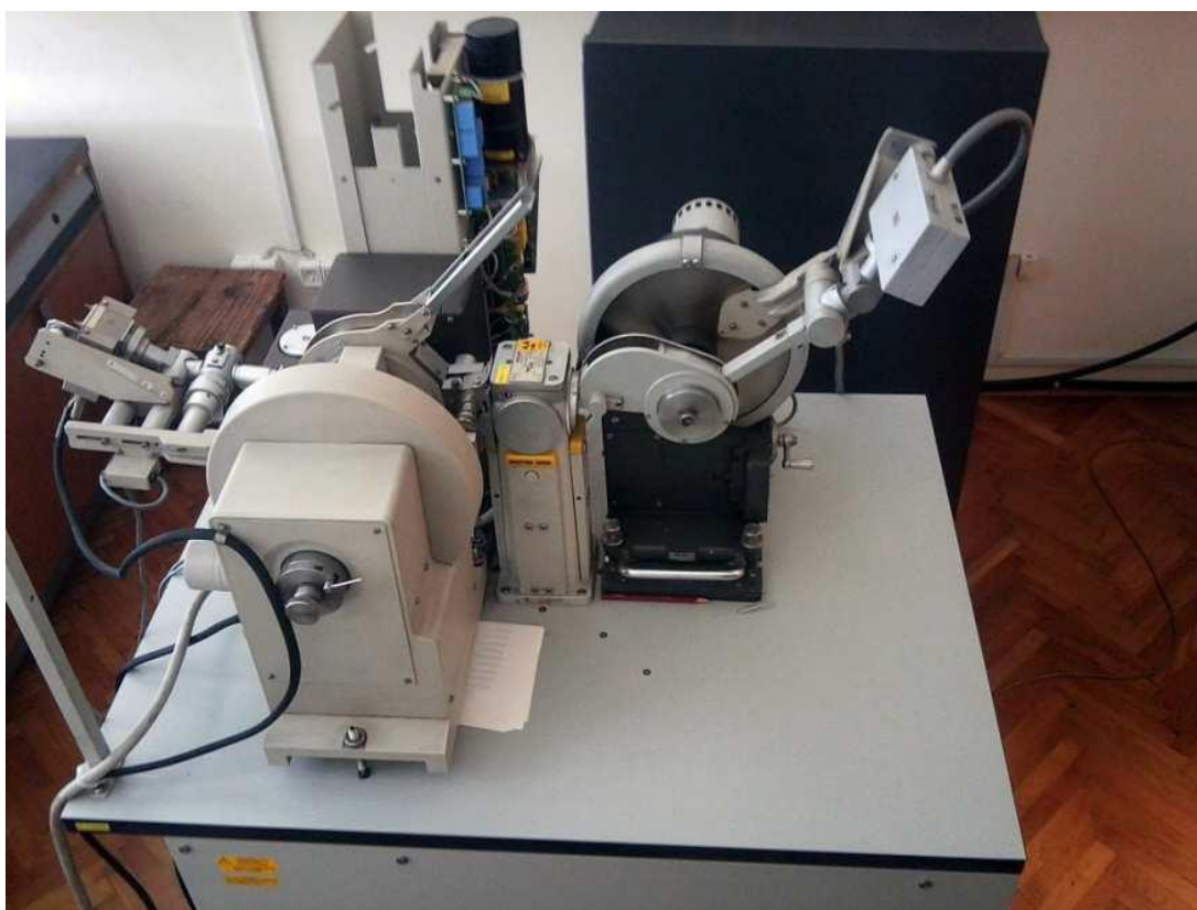
Slika 5.7. Rendgenski difraktometar s brojačem „Philips PW 1830“ (foto: Lucija Mihaljević)
