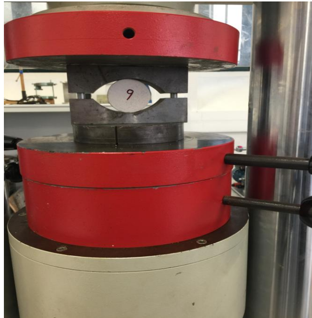
Slika 6-7 Indirektno ispitivanje vlačne čvrstoće Brazilskim testom
