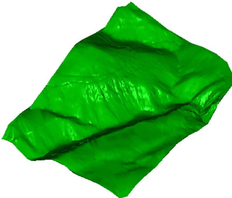
Slika 7-10. Renderirani triangulirani model šireg područja PK Tribošić
