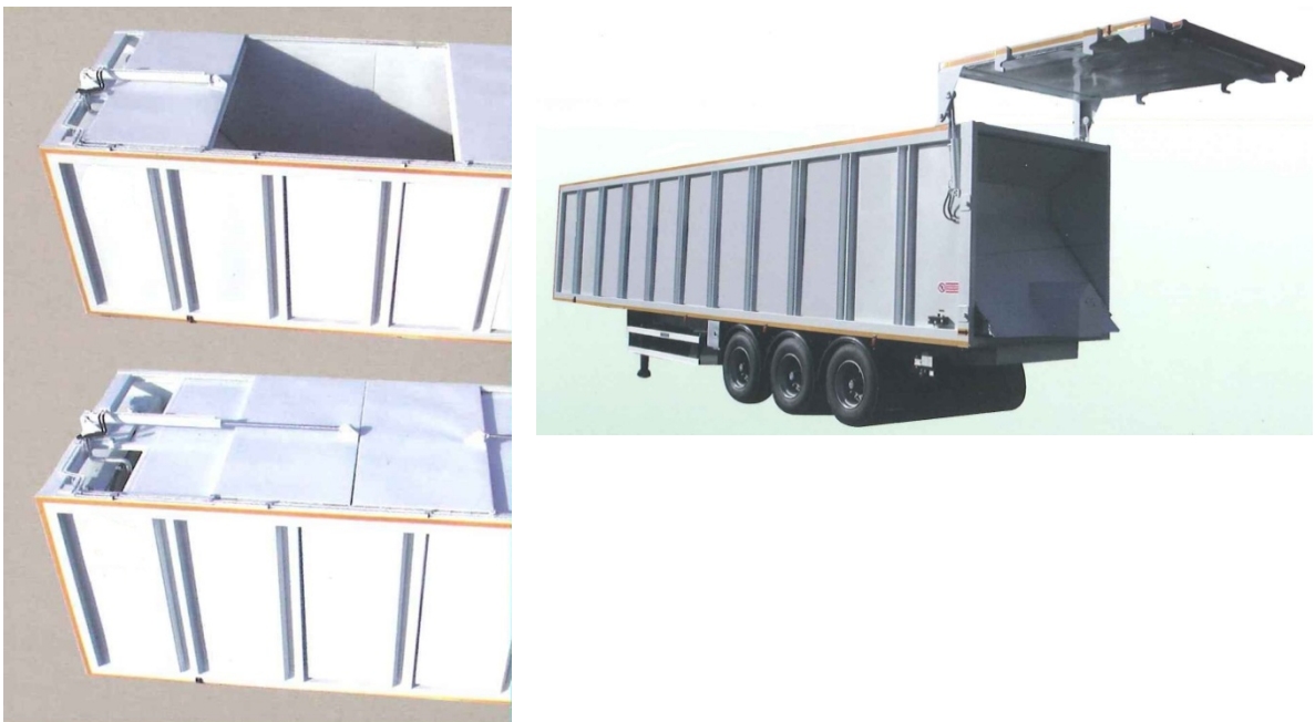
Slika 6-7. Prijevoz otpada kamionom s prikolicom (izvedba s prešanjem pomoću integrirane potisne ploče) (IPZ, 2014)
