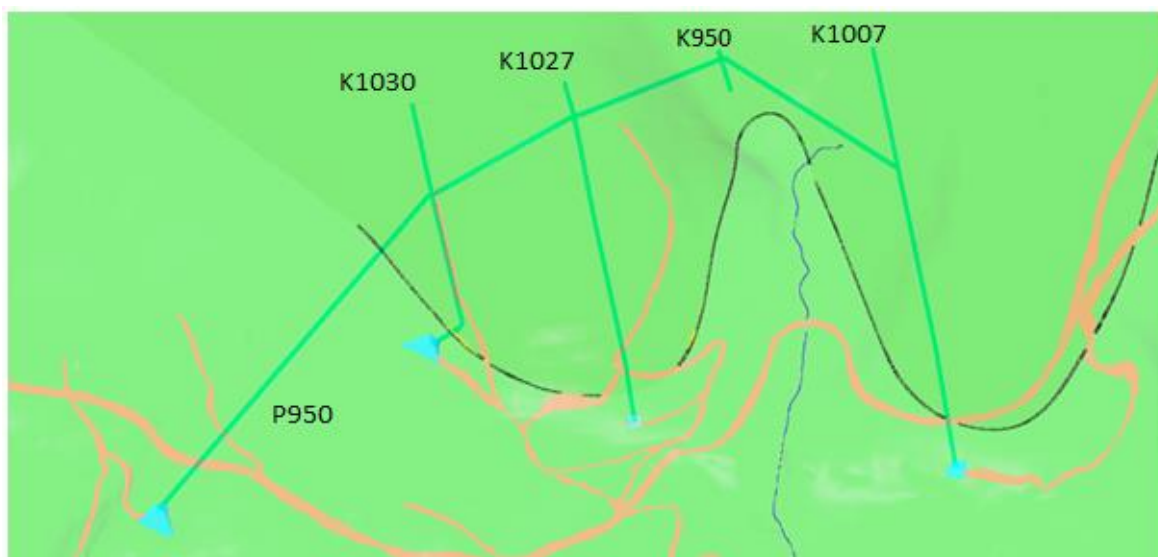
Slika 7-8. Renderirani prikaz površine terena, kontaktne plohe i istražnih hodnika između lokaliteta Skakavac i Crvene Stijene
