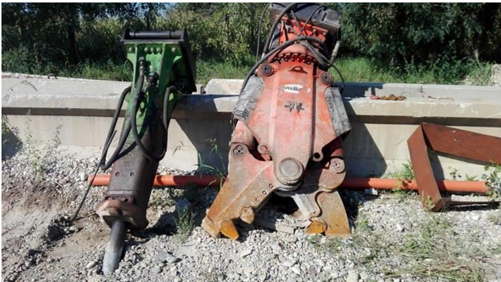
Slika 4-6. Hidraulički nastavci: udarni čekić i škare za rezanje
