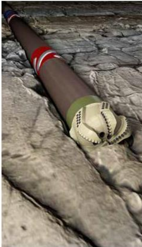
a) liner sa dlijetom nakon bušenja, pristupa se cementaciji, dlijeto služi kao peta lajnera, kroz njega se protiskuje cementna kaša
