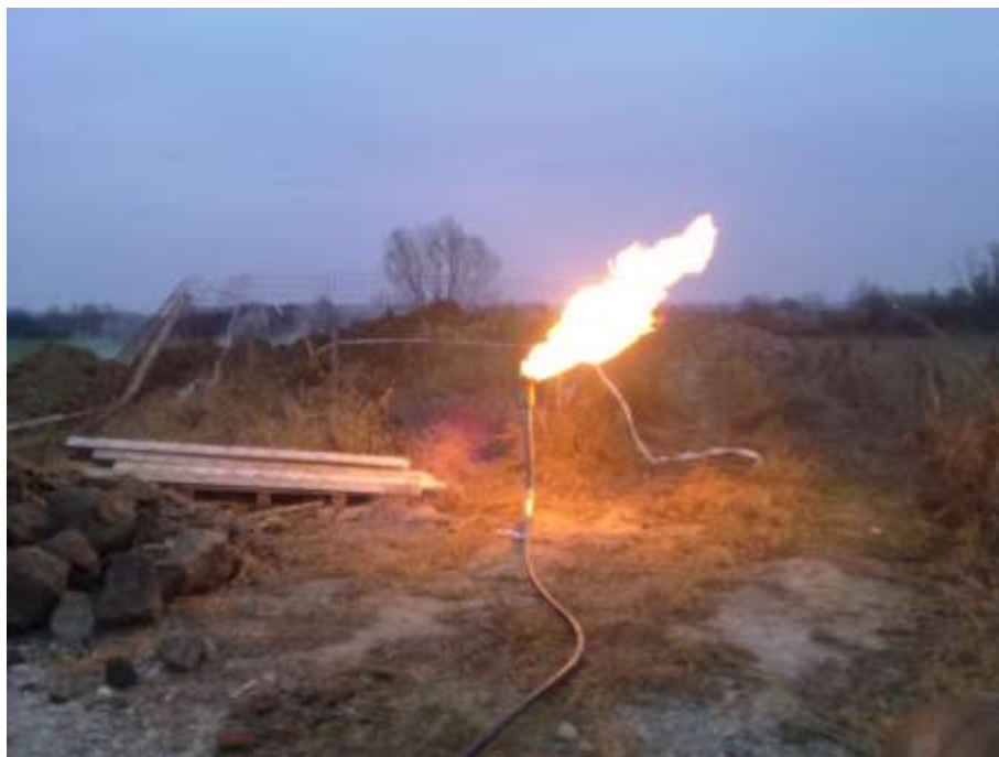
Slika 4-5. Spaljivanje plina na baklji
