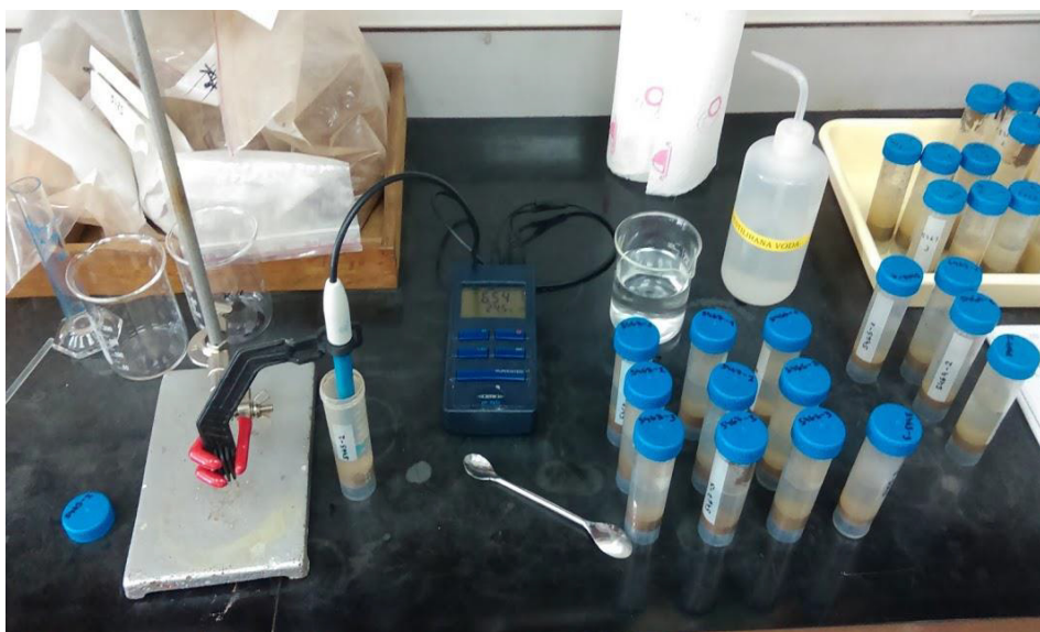
Slika 4.2. Mjerenje pH vrijednosti (foto: Dražen Tumara)
