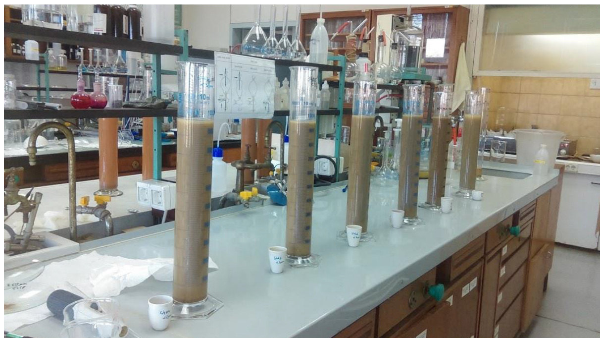
Slika 4.4. Izdvajanje frakcija < 2 \mu\text{m} (foto: Tin Borovčak)
