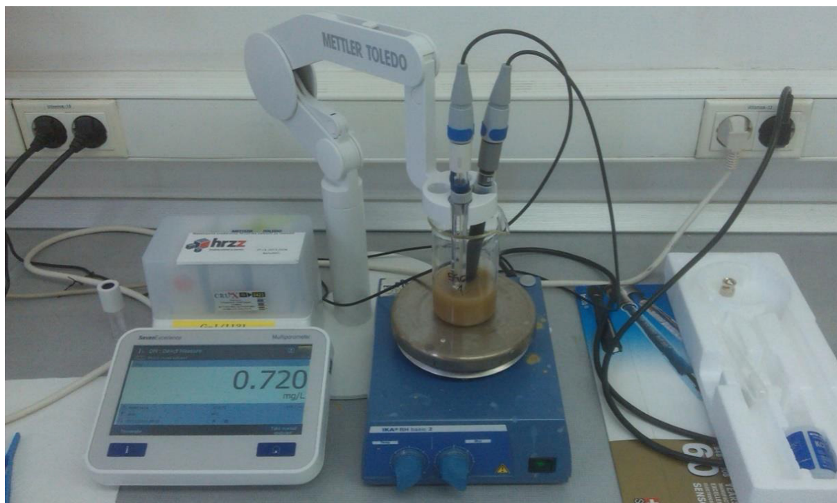
Slika 4.5. Mjerenje kapaciteta kationske izmjene (foto:Dražen Tumara)
