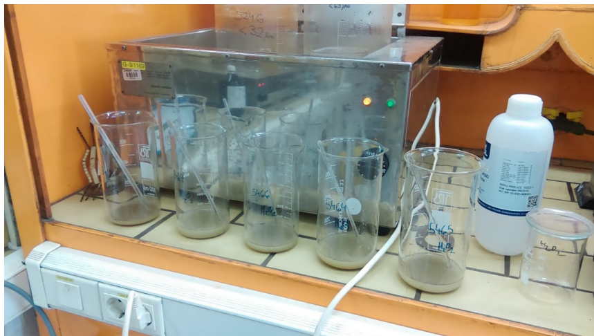
Slika 4.3. Određivanje sadržaja organske tvari (foto: Tin Borovčak)
