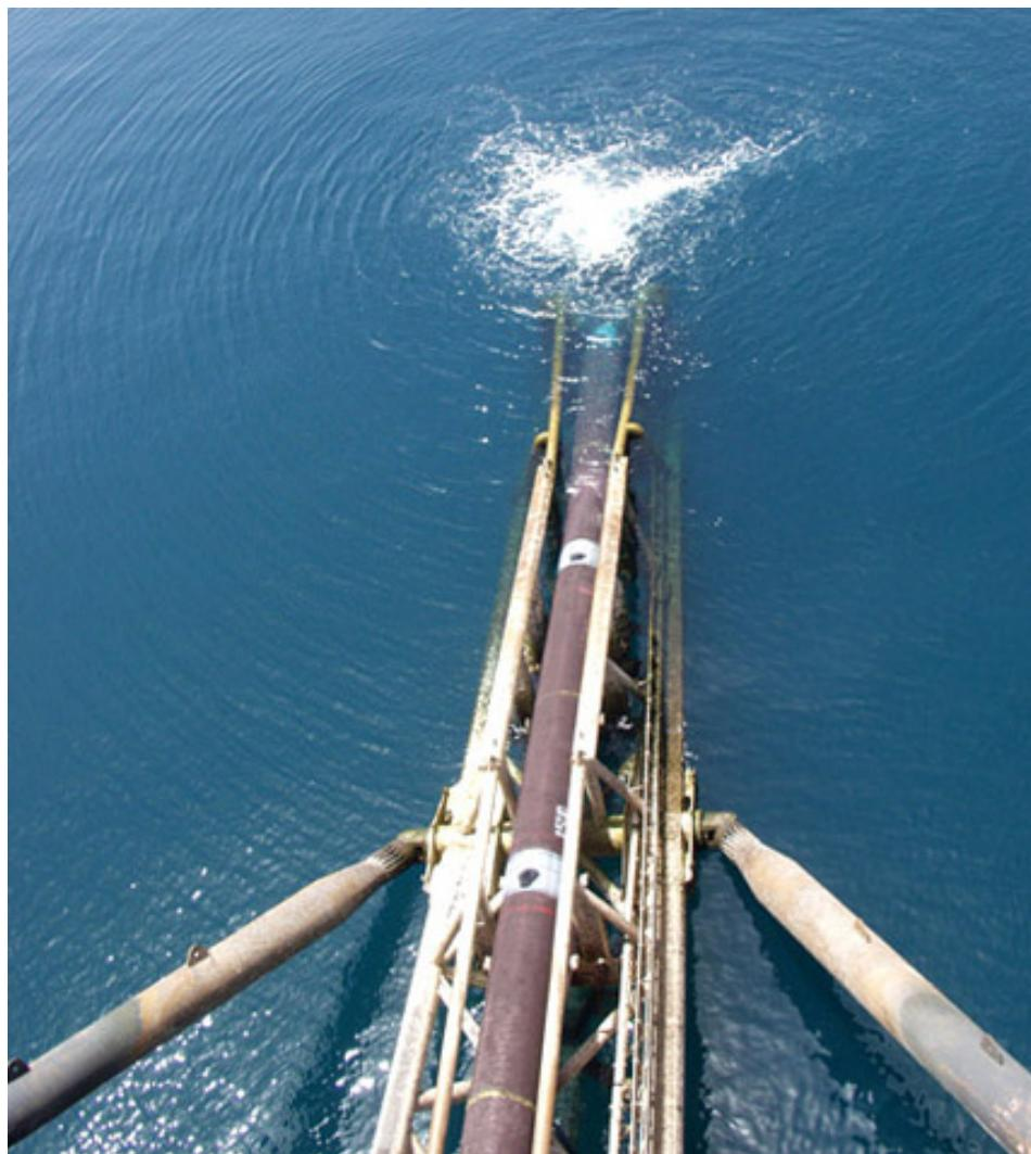
Slika 2-10. Vodilica za polaganje cijevi (*engl. „stinger”*) ([www.rigzone.com](http://www.rigzone.com))
