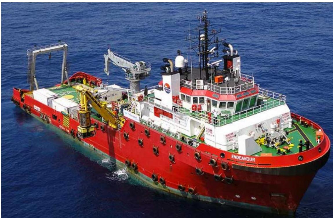
Slika 2-2. Brod za potporu daljinski upravljanim jedinicama (*engl. 'ROV Support Vessel'*)
