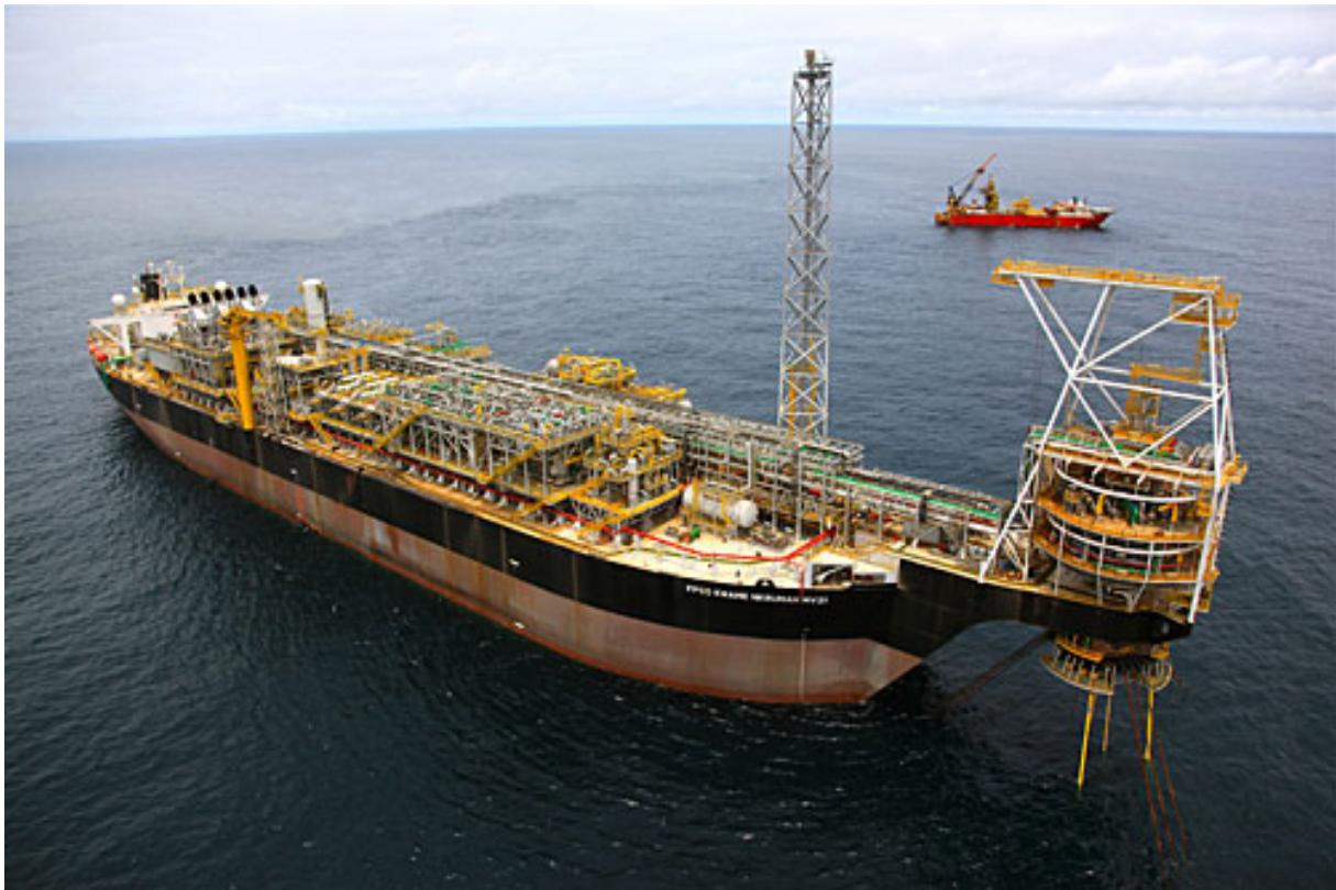
Slika 2-15. Plutajuće postrojenje za proizvodnju, skladištenje i istovar nafte ([www.sofec.com](http://www.sofec.com))
