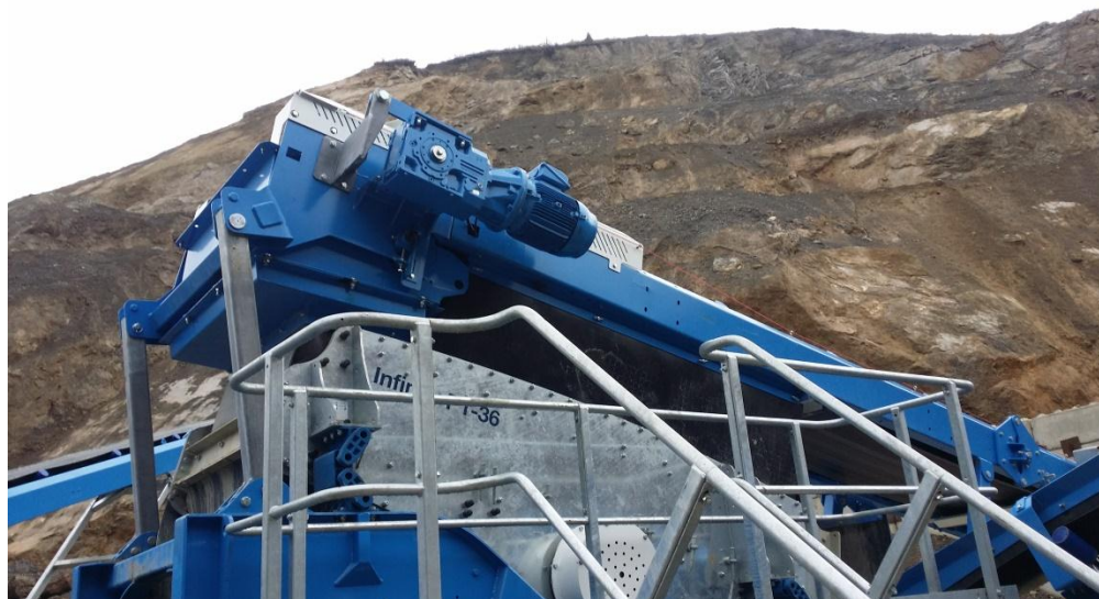
Slika 3-3. Primarno jednoetažno sito P1-36
