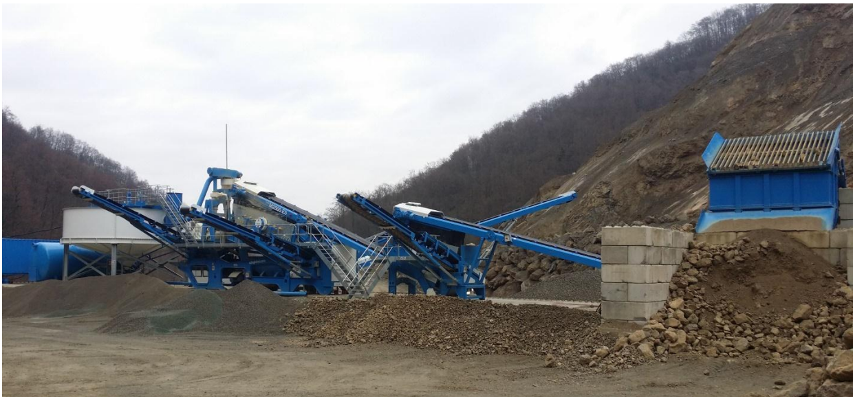
Slika 3-1. Polumobilno postrojenje za oplemenjivanje mokrim postupkom M2500 E5 x
