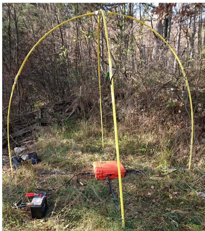
Slika 5-2. Antena za emitiranje visokih frekvencija
