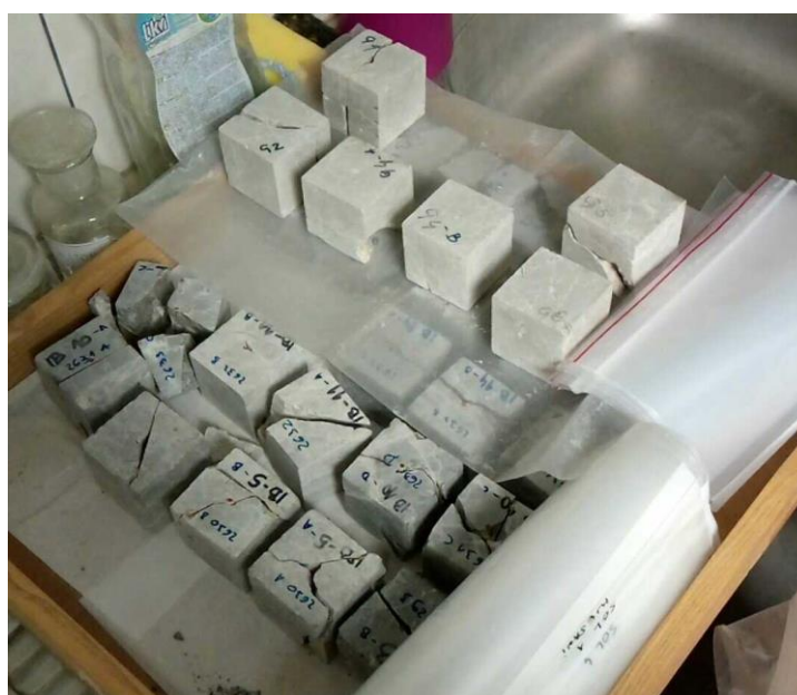
Slika 5.8. Odlomljeni uzorci nakon PLT mjerenja
