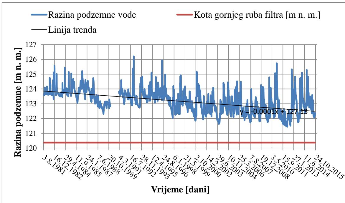
**Slika 4.10. Usporedba kote gornjeg ruba filtra zdenca B8 i nivograma piezometra 482 udaljenog od zdenca 304 m.**
