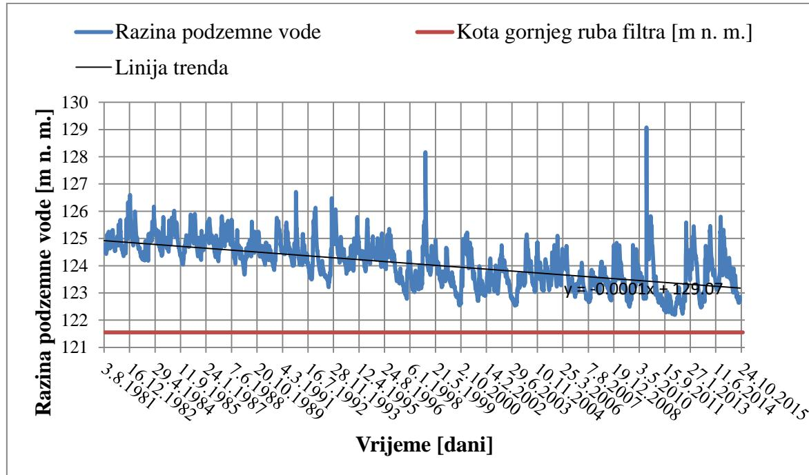
**Slika 4.6. Usporedba kote gornjeg ruba filtra zdenca B4 i nivograma piezometra 494 udaljenog od zdenca 128 m.**
