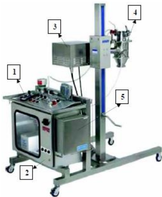
Slika 4-5. Prijenosni sustav inertizacije mlina s kontrolom koncentracije kisika (Mačković, 2012)
