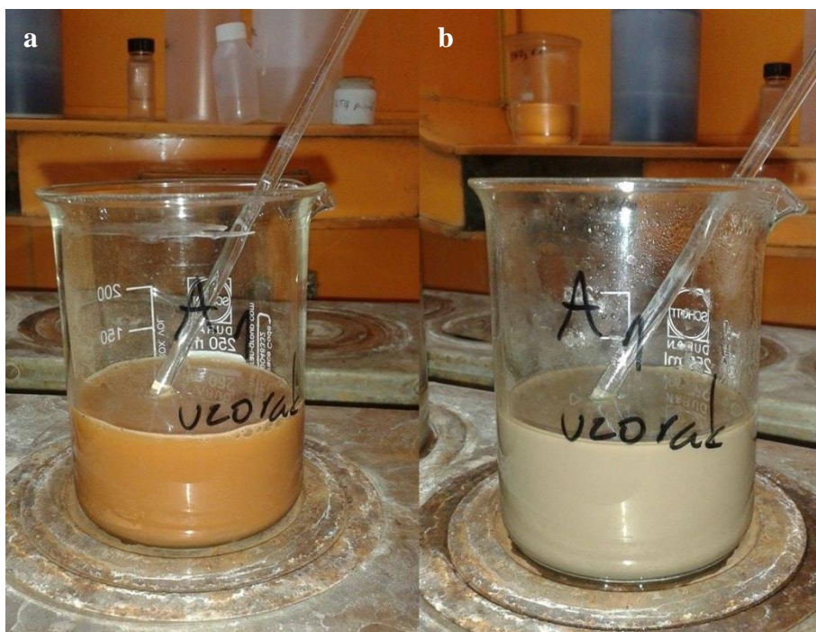
Slika 4-10. Suspenzija uzorka a) prije i b) poslije tretmana otapanja Fe i Mn oksida i hidroksida DCB metodom
