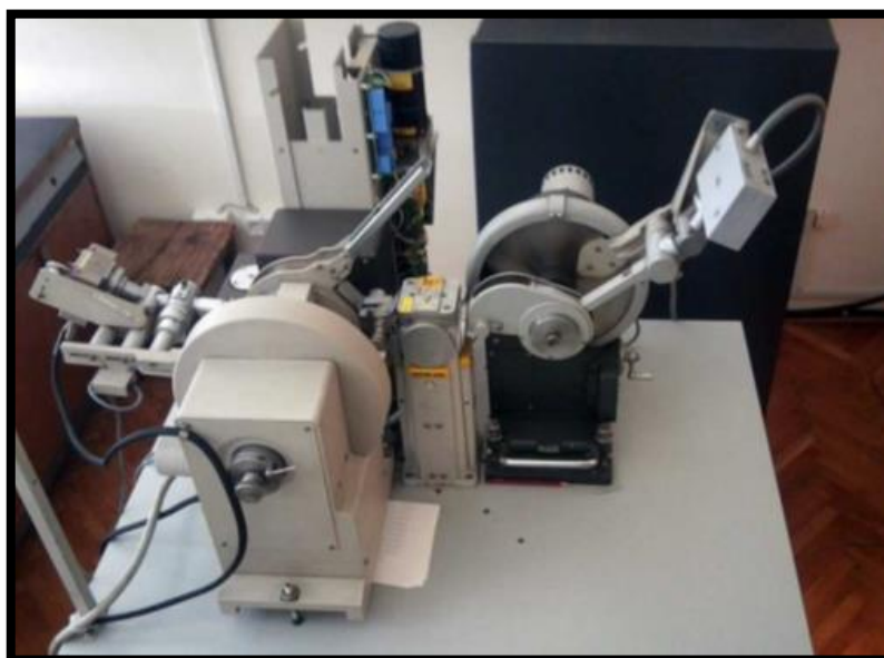
Slika 5-15. Rendgenski difraktometar s brojačem „Phillips PW 1830“ (foto: Lucija Mihaljević)
