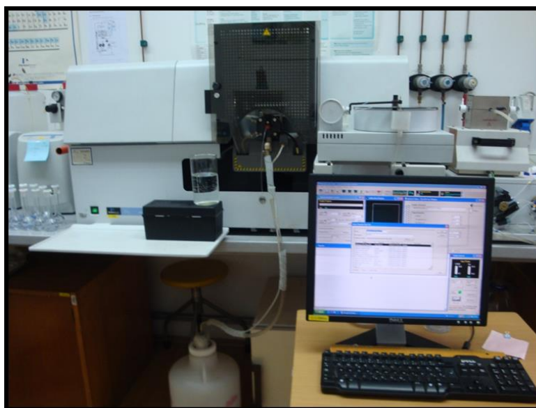
Slika 5-11. Atomski apsorpcijski spektrometar PerkinElmer Aanalyst 700 (foto: Lucija Mihaljević)
