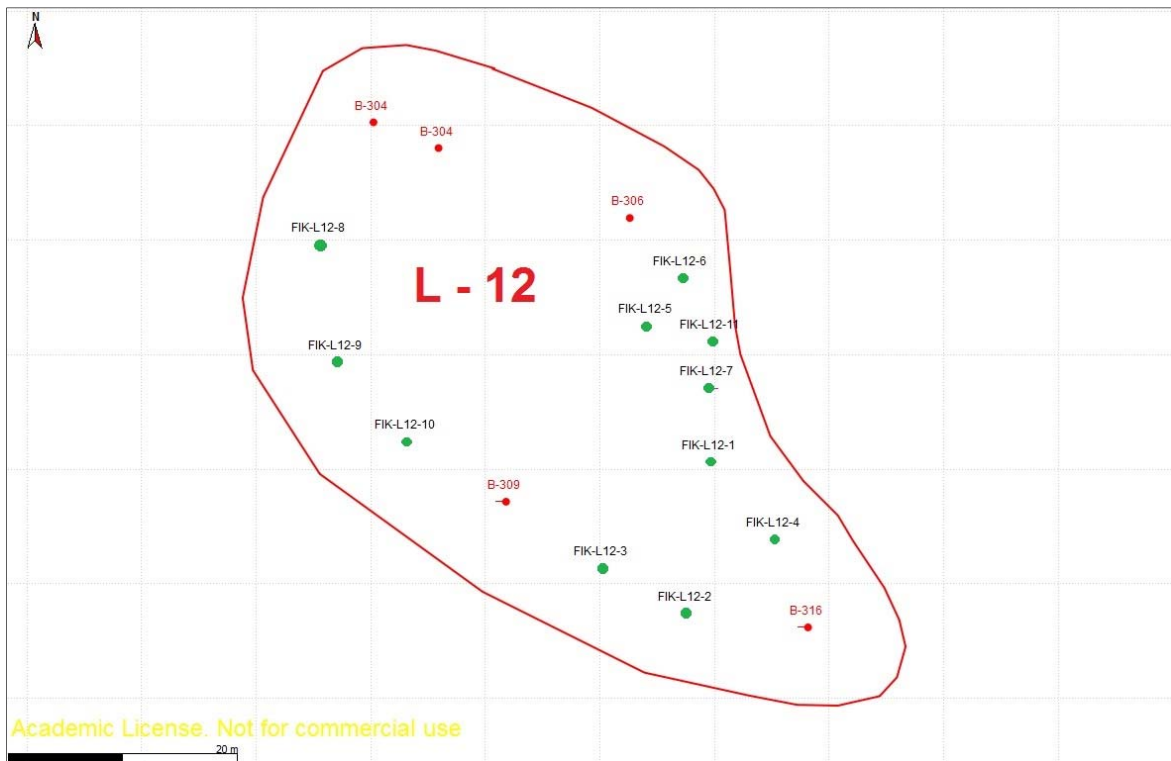
Slika 5.12. Postavljanje fiktivnih bušotina (FIK) na primjeru ležišta L-12. Bušotine označene crvenom bojom su prave bušotine na boksit, a bušotine označene zelenom bojom su fiktivne bušotine.
