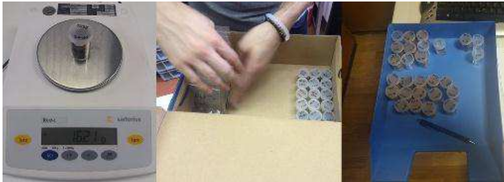
Slika 5.5. Priprema uzoraka za mjerenje magnetnog susceptibiliteta na magnetometru.
